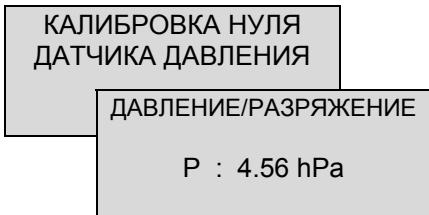
В момент вызова данной функции при этом автоматически отключается насос и производит «Калибровка нуля датчика давления» на входе «hPA» газоанализатора и дальнейшее изменение давления выводится на дисплей,. Для измерения давления существует два пути:
