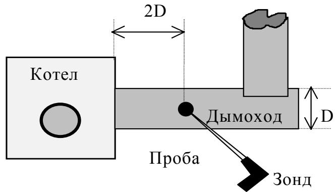
в. Схема расположения зонда в газоходе
